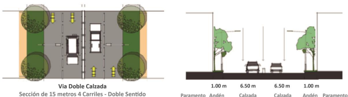
Ilustración 126. Perfil Vía Interna propuesta para el Plan Parcial EuroPark
